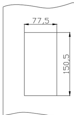
图 B-9 安装尺寸：150.5×77.5mm
