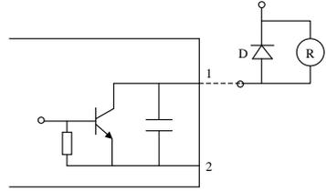
图 6-13 OC 输出端子的内部线路
