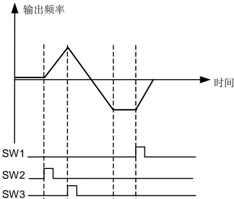
图 6-2 三线控制模式频率输出图
