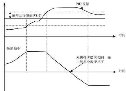
图 6-30 双极性 PID 控制方式
