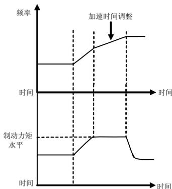
图 6-20 加速力矩限制示意图
