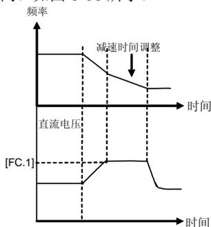
图 6-35 减速中的电压失速保护
