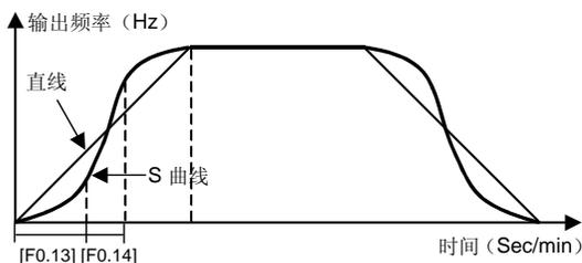
图 6-3 加减速曲线
