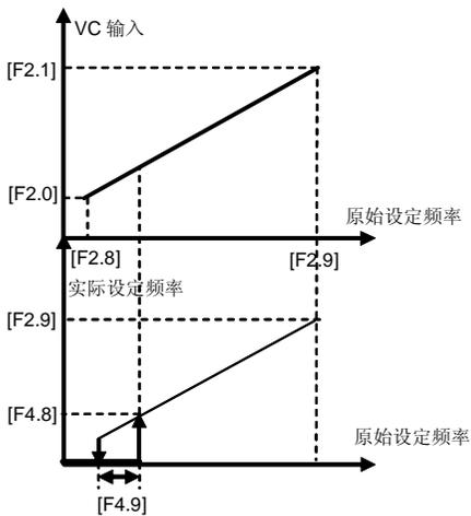
图 6-18 频率输出过零点曲线
