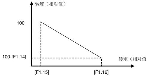
图 6-9 下垂控制作用时的电机特性
