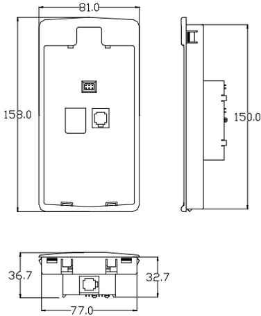
图 B-1 操作面板安装底座的尺寸
