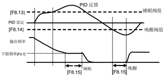
图 6-33 PID 控制的睡眠与唤醒功能
