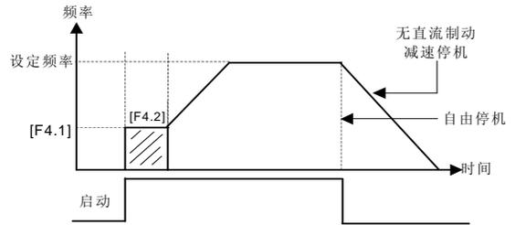
图 6-17 启动与停机频率输出曲线
