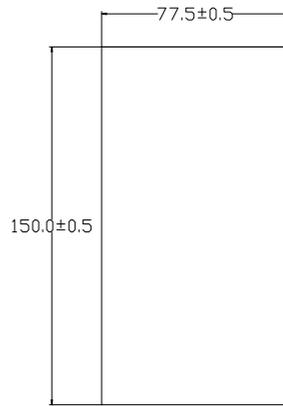
图 B-2 操作面板底座安装开孔尺寸
