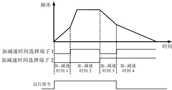
图 6-22 加、减速时间的外部端子选择方式
