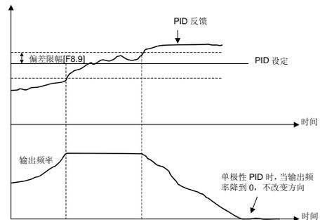
图 6-29 单极性 PID 控制方式
