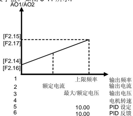
图 6-11 模拟输出端子的模拟输出内容
