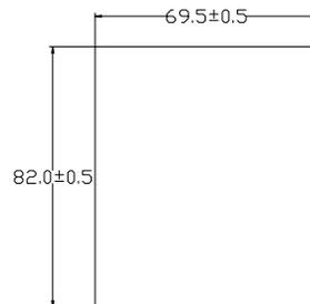
图 B-4 小操作面板底座安装开孔尺寸
