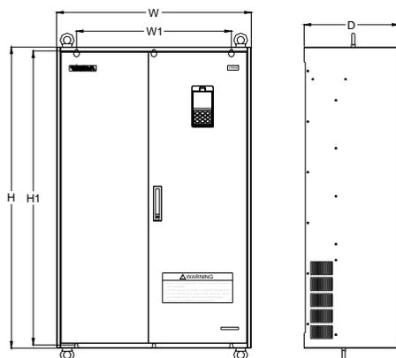
图 2-4-D 变频器的安装尺寸
